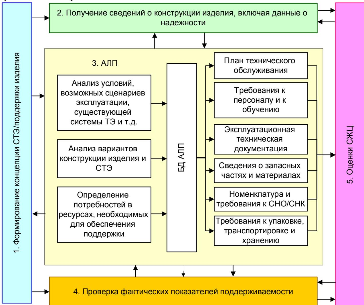
Рис.1. Логическая схема взаимосвязи основных процессов ИЛП
