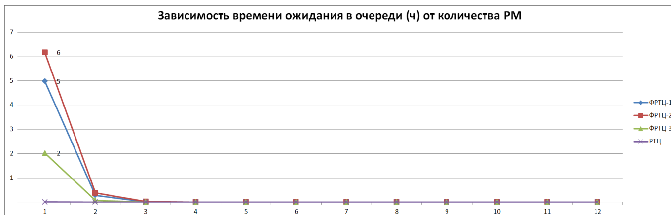
Рис. 9-45 – Диаграмма зависимости суммарного времени ожидания планового и непланового ТО от количества рабочих мест для каждого СЦ
